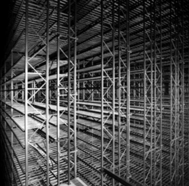
parfaits pour les palettes et les cartons homogènes et permettent de contrôler la rotation des stocks ainsi que gagner de la place. C'est une structure compacte où chaque niveau dispose de linéaires de tapis à galets qui permettent de faire glisser facilement les unités de charge grâce à une petite inclinaison. Dans le système à chariots, chaque palette, sauf la dernière, est déposée sur un chariot qui se déplace sur des rails avec une inclinaison positive.
